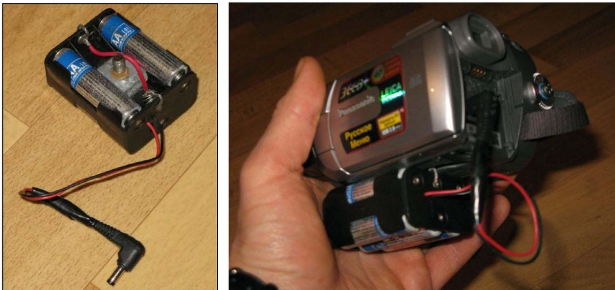
**Фото 102** Батарейный блок и его крепление видеокамере. В центре блока - винт для крепления блока в штативное гнездо видеокамеры.
