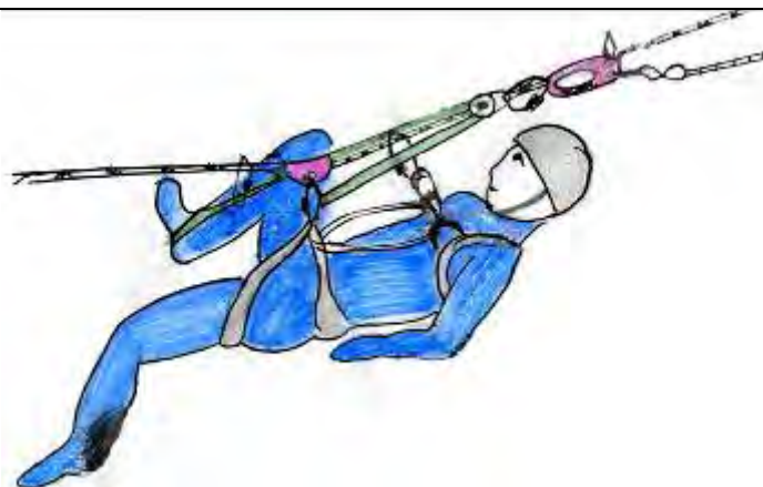
Мал. 14.4. Порядок підйому легко потерпілого спортсмена з опорою на одну ногу, а також варіант організації командної страховки за допомогою рухомої транспортної вірьовки
