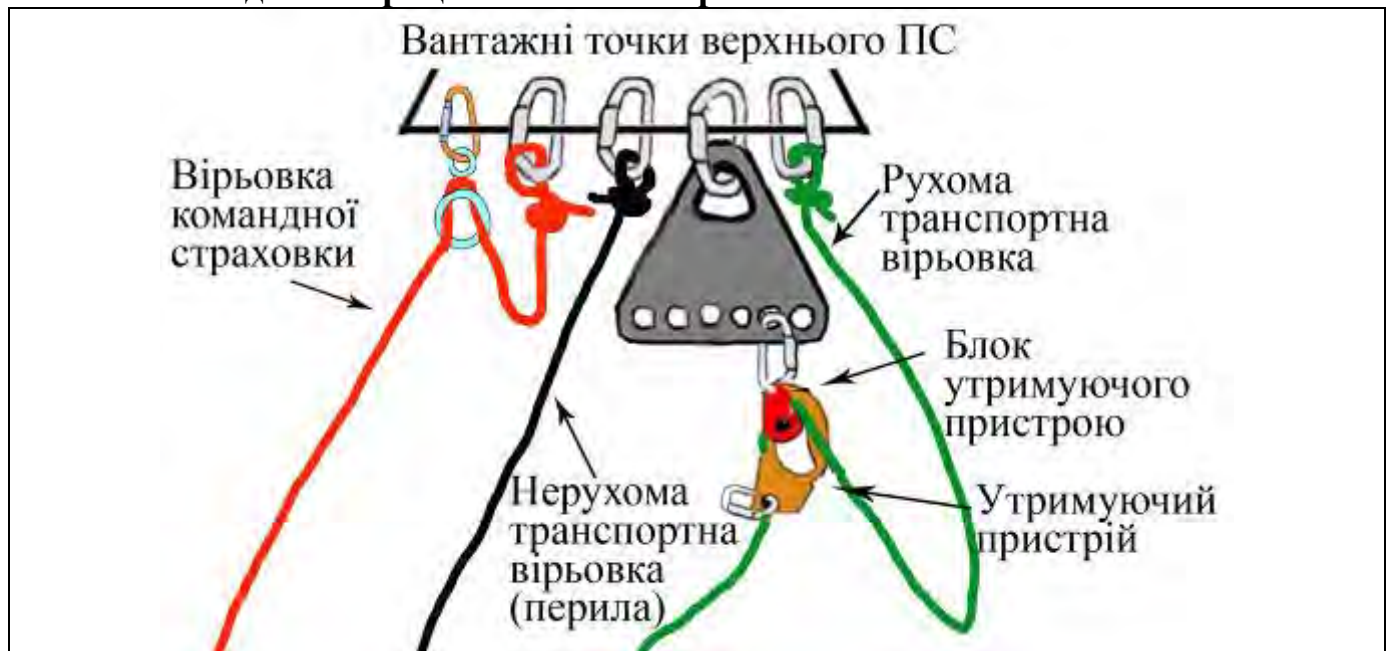
Мал. 14.1. Закріплення страхувальної та транспортних вірвовок, а також організація транспортної системи в верхньому ПС з окремою вірвовкою командної страховки
