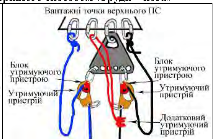
Мал. 12.2. Закріплення транспортних вірвовок, а також організація транспортної системи в верхньому ПС без окремої вірвовки командної страхівки
