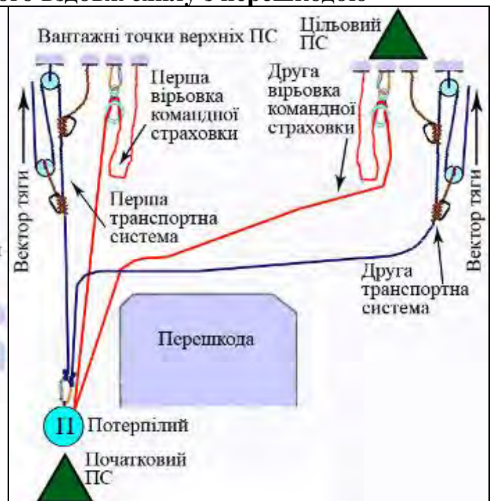
Мал. 21.2. Варіант транспортних систем для підйому з обносом з окремими вірвовками командної страховки
