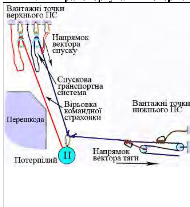
Мал. 21.1. Варіант транспортних систем для спуску з відтяжкою з окремою вірвовкою командної страховки
