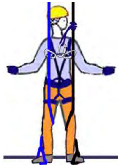
Мал. 11.5. Закріплення легко потерпілого спортсмена до транспортних вірвовок, а також варіант організації командної страхівки за допомогою однієї з транспортних вірвовок та схоплюючого вузла, зав'язаного навколо неї, петля від якого закріплюється до грудного поясу ІСС спортсмена
