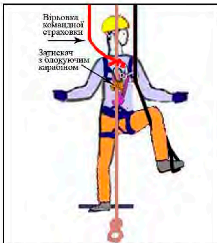
Мал. 13.3. Закріплення легко потерпілого спортсмена до транспортних вірвовок, а також варіант організації командної страховки окремою вірвовкою
