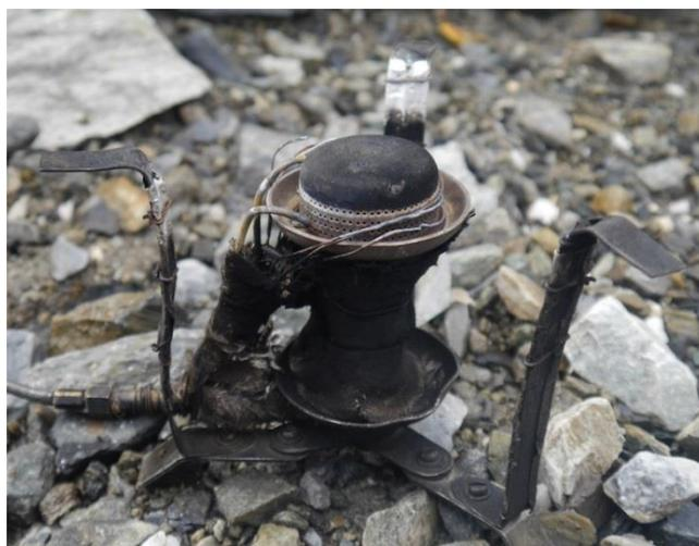
Шмель ("Франкенштейн") после модификации для лучшего прогрева топлива. Видно проволоку, которая ведет к трубке-переходнику.
