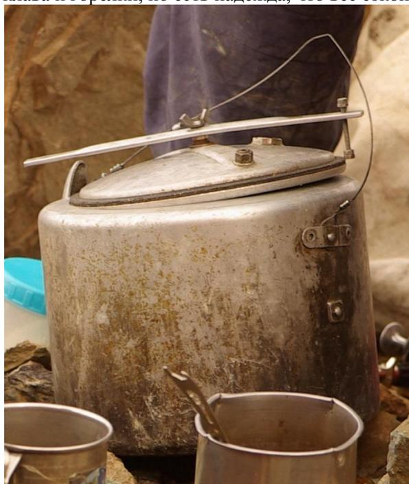
Автоклав со снятым манометром
