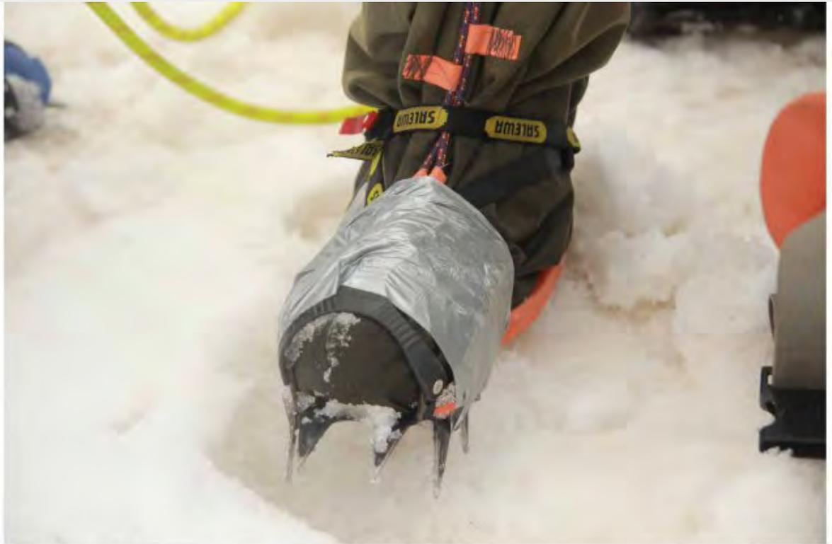
фото 7.21 Кошка, сломанная пополам при перешагивании через трещину.
