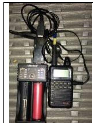
Рации ruxing px-2 Рация может работать в диапазоне 400-470 прием/передача и 136-174 прием (в форумах проскакивала информация что диапазон 1xx можно раскрыть и на передачу) Выходная мощность передатчика 2W малый вес (130гр), зарядка от USB. в радио используются аккумуляторы совместимые со старыми нокиевскими BL-5C на 1100mAh и по этому были взяты найденные запасные акумы, еще по одному запасному аккумулятору. Перед
