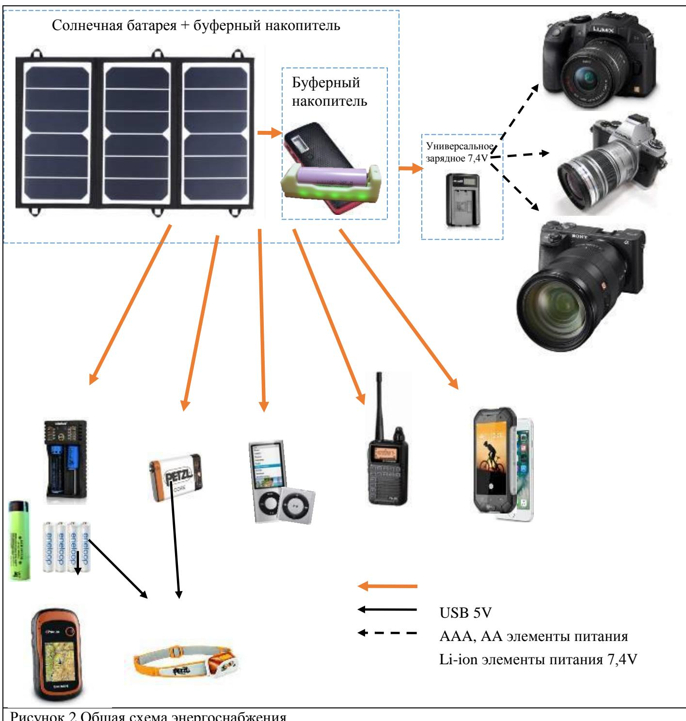
Рисунок 2 Общая схема энергоснабжения
