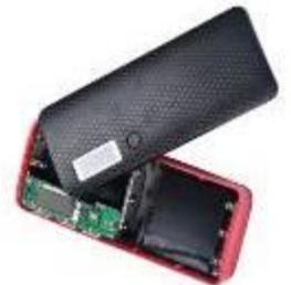
2. [Китайский нонейм корпус на 5x18650 аккумуляторов](#) с 5-ю аккумуляторами формата 18650. Пауербанк был дополнительно оборудован выходом на 3.7V для возможности питания вместо штатной батареи фотоаппарата Panasonic. Powerbank имеет 2 USB выхода, может потреблять 2А для заряда банок и выдает до 1.8А, но от этого пауербанка фотоаппарат SONY заряжаться отказывался.
