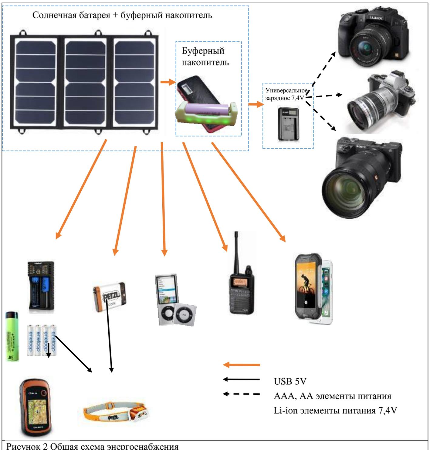
Рисунок 2 Общая схема энергоснабжения
